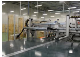
Linia produkcyjna do automatycznego montażu i pakowania kabin prysznicowych
