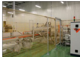
Linia produkcyjna do automatycznego montażu i pakowania kabin prysznicowych
